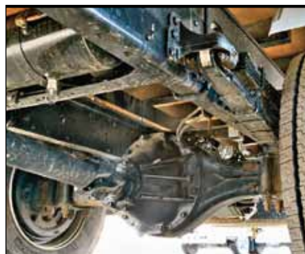
Ведущий мост с гипоидным редуктором собран на балке типа «банджо»
