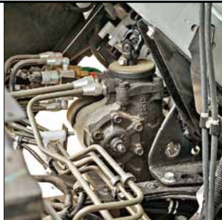
Берегите от удара передний левый угол кабины: там дорогой ГУР
