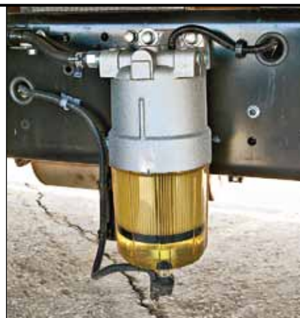
В отличие от праворульных «Форвардов» этот сразу идет с сепаратором
