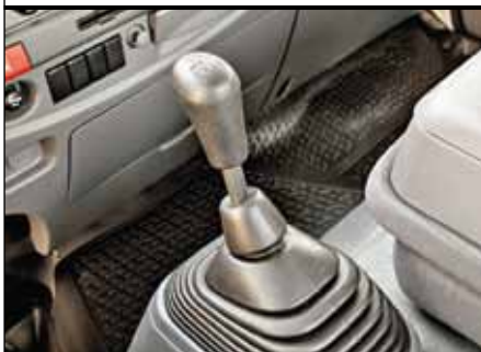
Рычаг переключения передач соединен с КП двумя гибкими тросами
