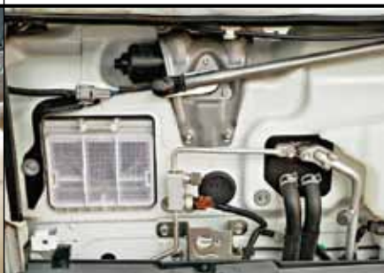
Шланги идут в «печку», стальные трубки – в испаритель кондиционера
