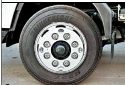
На FVR34 японцы изначально предусмотрели 10 фланцевых гаек
