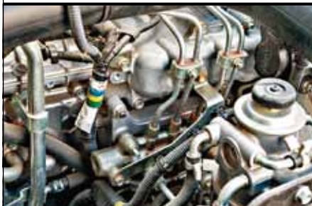
Топливная рампа Common Rail фирмы Denso весьма компактна
