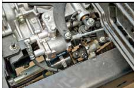
Пнеумосуилитель переключения – редкость на 6-ступенчатых КП
