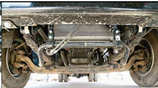
Изогнутая у колес балка выдает предназначение машины: для хороших дорог она в самый раз, а вот для проселка...
