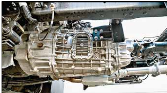
Коробка передач 6-ступенчатая без демультипликатора. Предусмотрен отбор мощности для спецнастроек
