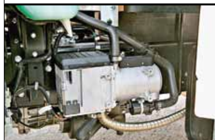
Машину можно дооборудовать автономным отопителем Eberspacher
