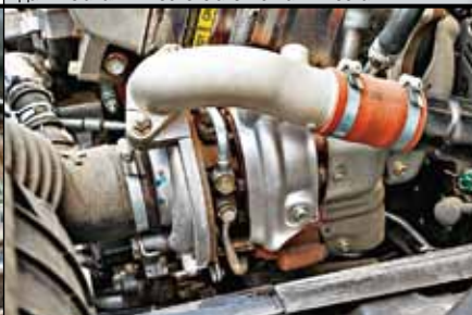
Настройка турбокомпрессора позволяет снимать с мотора до 210 л.с.
