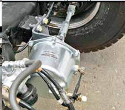
Стояночный тормоз – с пневмоприводом и энергоаккумуляторами
