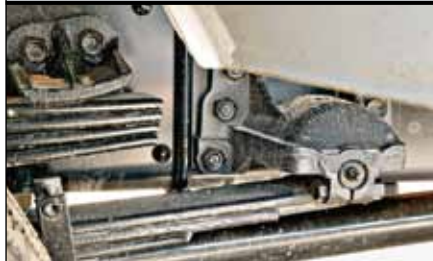
Рессоры подвесок – параболические. Задние – еще и с подрессорниками
