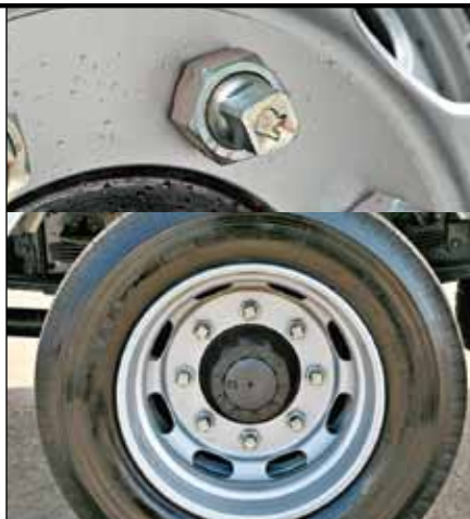
Колеса FSR90 класса Евро-4 крепятся восемь гайками с футорками
