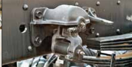
...да и шарниры рессор на втулках тоже оснащены прессмасленками
