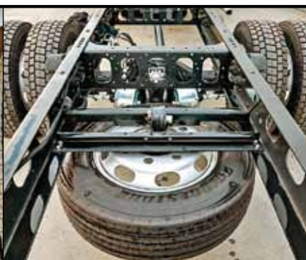
Запасное колесо подвешено на свес рамы и будет закрыто кузовом
