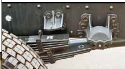
Рессоры подвесок – параболические. Задние – еще и с подрессорниками
